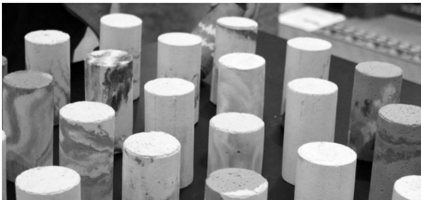
Oben/Unten: Freigegossene Lehmbetonzylinder Mitte: Freier Lehmbetonguss in texturierter Schalung (Quelle: Boltshauser, Roger; Veillon, Cyril; Maillard, Nadja (2020): Pisé. Stampflehm – Tradition und Potenzial, Triest Verlag, Zürich, S.210.)
