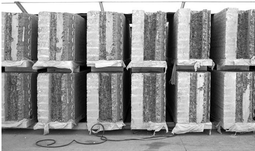
Erstmalige Verwendung von vorproduzierten Stampflehmfertigelementen mit integrierter Kerndämmung und geothermischer Wandheizung. Produktion für den Alnatura Campus
