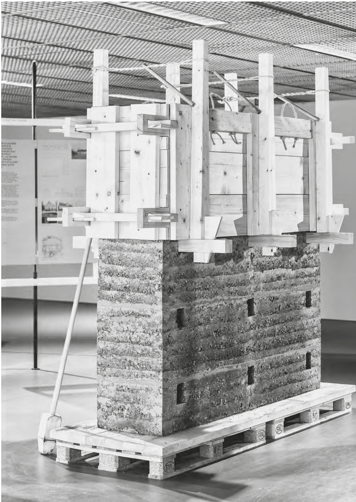
Historische Lehmschalung, wie sie im 18. Jahrhundert der Architekt François Cointeraux in seinem Lehrbuch zum Lehmabau beschreibt. Lehmschalung nachgebaut vom Studio Boltshauser
