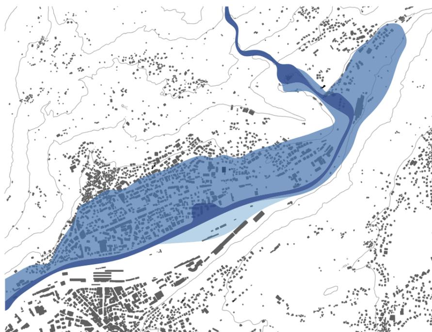
Abb.27 Überflutungs-Prognose Naters bei Seeausbruch
