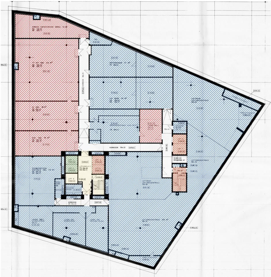
Für die intensive Flächennutzung und die technisierten Arbeitsplätze wird eine aufwendige Infrastruktur benötigt. Die Untergeschosse 5 und 6 stellen das Zentrum der haustechnischen Anlagen dar. Die Räumlichkeiten beherbergen die Lüftungssysteme, die Heizungssysteme, die Elektrizität und die EDV-Räume. Die Technik und elektrische Versorgung wird von Kontrollräumen aus gesteuert und überwacht.
