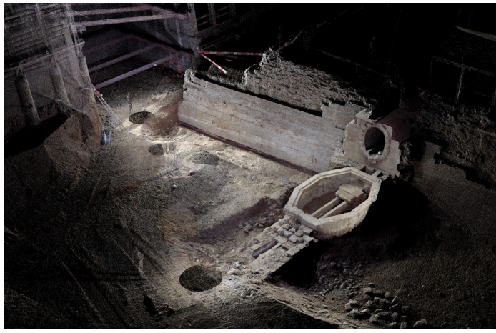
Pointcloudmodell der Ausgrabung mit dem Wolfbachkanal und Überresten der Schanzenanlage. (Bild: Matthias Vollmer, Lehrstuhl. Girot, Daten: AfS GeoZ Stadt Zürich)
