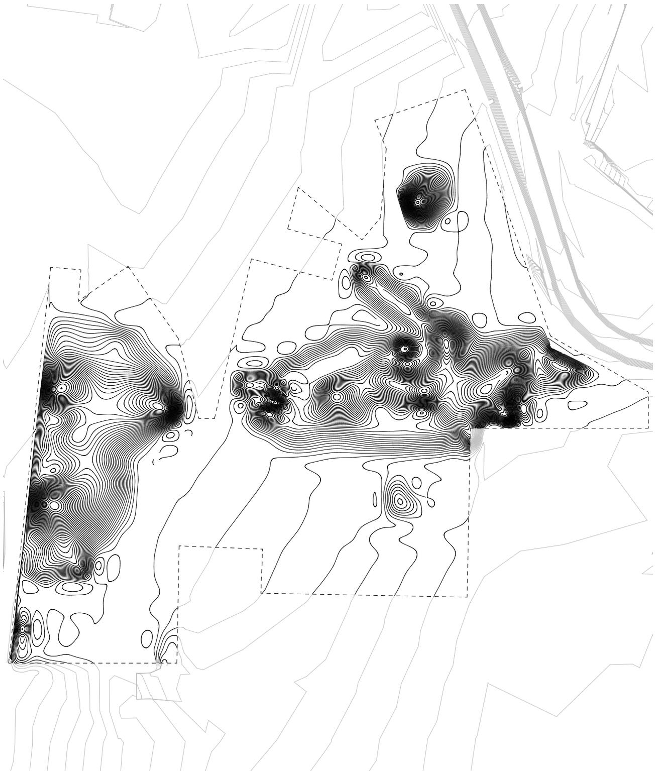
Topographie Sole, generiert anhand Kontamination aufzeigender Bohrprofile und Leckagen
