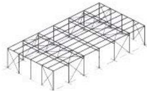
*Bild 2 b – Stützen und Binder:
