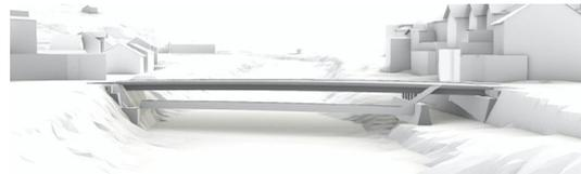
Unabhängiger vorgespannter Brückenträger
